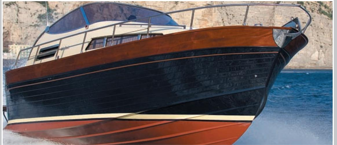
Dispone di una carena di tipo planante monoedrica, che consente di raggiungere agevolmente una velocità di 34 nodi e di navigare, nel massimo comfort, alla velocità di circa 28 nodi di crociera.
